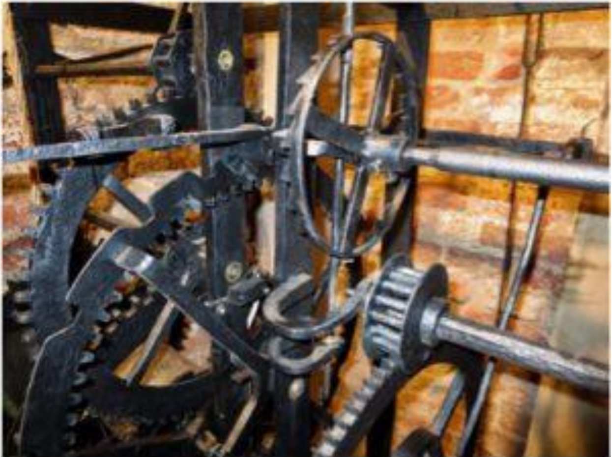
Afbeelding 4 Gedeelte van het torenuurwerk van de kerktoren van het dorp Feinsum (Finkum)
